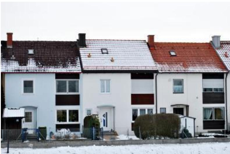
**00427.jpg:** Der Schnee auf dem Dach des mittleren Reihenhauses zeugt von einer besseren Wärmedämmung, als sie die „Nachbarn“ vorweisen können.
